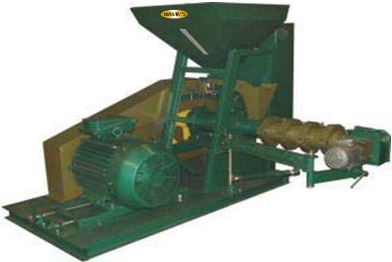
EXTRUDER MESEB(HS)-200 (200Kg/Hour capacity Soy Nugget)
